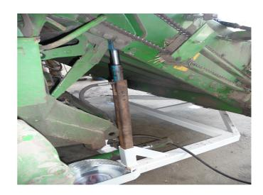
Chariot 3 roues qui se positionne sous le convoyeur de la moissonneuse associé au kit de démontage du contre batteur. Permettent d'éviter les accidents, de gagner du temps et de l'autonomie.
